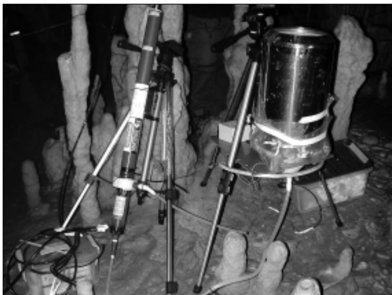
Figura 2. Fotografía en el interior de Kaite en la que se aprecian la sonda multiparamétrica (izquierda) y el pluviómetro (derecha), para medida de parámetros fisicoquímicos y tasa de goteo, respectivamente.
