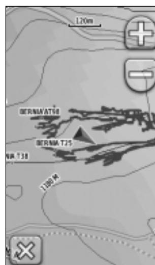
figura 8. Pantalla del GPS mostrando la topografía de la cueva sobre el mapa y el cursor triangular de posición
