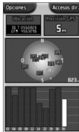
figura 2. Pantalla del GPS mostrando la geometría, la calidad de las señales, las coordenadas y la precisión estimada
