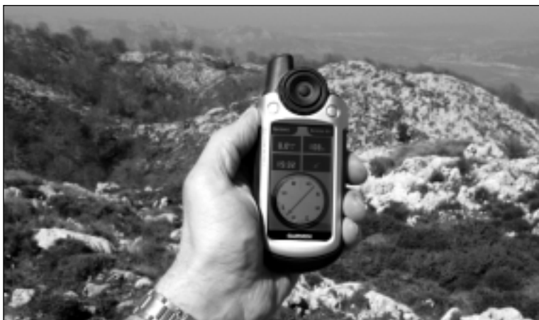
figura 1. Un receptor GPS de última generación. La antena apunta hacia el cielo (Foto C. Puch).
