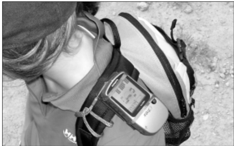
figura 5 El receptor sujeto a la hombrera de la mochila (Foto C. Puch).
