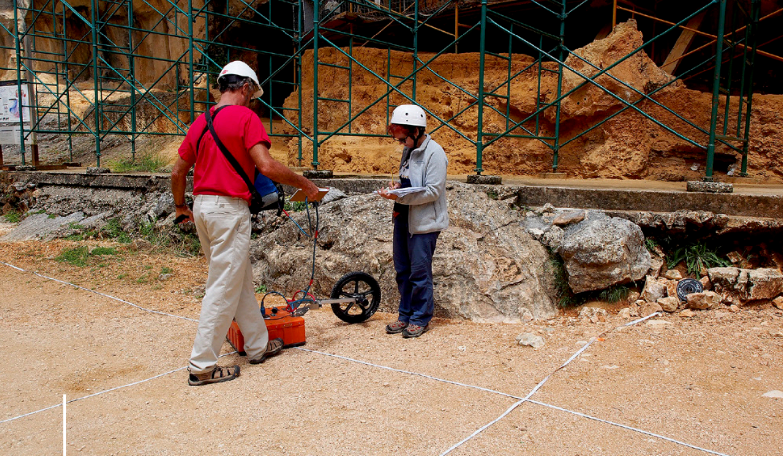
Prospección con georradar frente a Trinchera Galería. Foto: Miguel Ángel Martín
