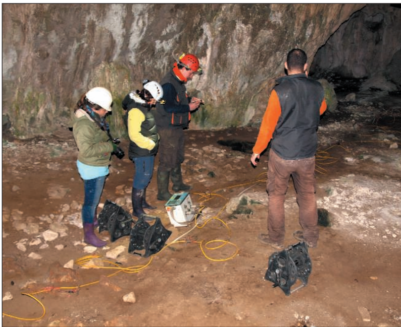
Foto 2. Syscal Pro durante la toma de datos en el Portalón de Kaite. Foto M. A. Martín
