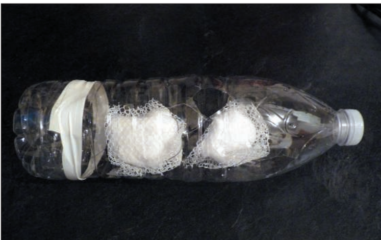
Detalle constructivo del captador de algodón de farmacia, envuelto en una redcilla de plástico y protegido a su vez dentro de una botella de plástico perforada. Este captador es mucho más robusto que el anterior. Foto Miguel A. Rioseras
